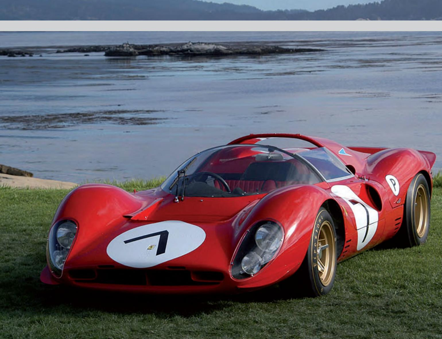
Deux des 330 P4 ont été convertis aux spécifications «350 Can-Am» en réduisant la carrosserie et en installant une version légèrement plus grande du moteur V12 à double came. La troisième 330 P4 a été abandonnée.
