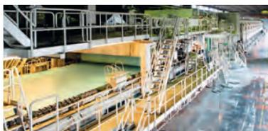
Grâce à une machine à papier, la pâte est aplatie, étirée et séchée sur des cylindres chauffés à la vapeur pour devenir une immense feuille de papier. On peut ainsi fabriquer jusqu'à **110 km de papier** par heure.
