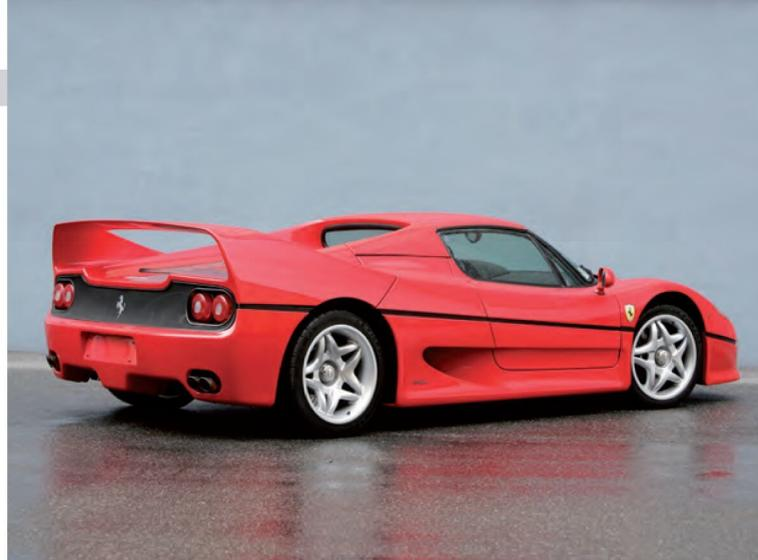
modèles Ferrari, mis à part sa ligne latérale découpée à finition noire satinée et ses feux arrière traditionnels. Toujours toute en courbes, avec des orifices d'entrée et de sortie d'air et une aile arrière encore plus radicale que celle de la F40, elle se distinguait par la forme de sa carrosserie qui se voulait plus aérodynamique qu'esthétique. Elle possédait toutefois un toit rigide amovible, offrant à ses occupants un avant-goût de l'expérience de F1.
